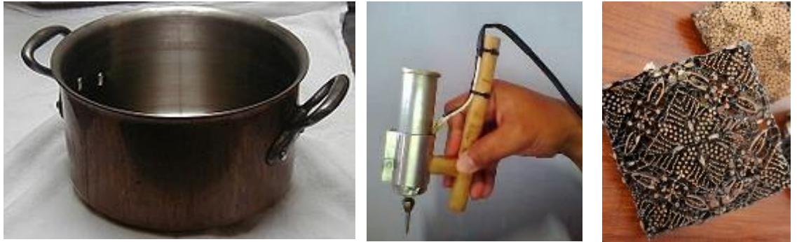
Peralatan pematikan, panci/kenceng tembaga, canting listrik, cap batik
